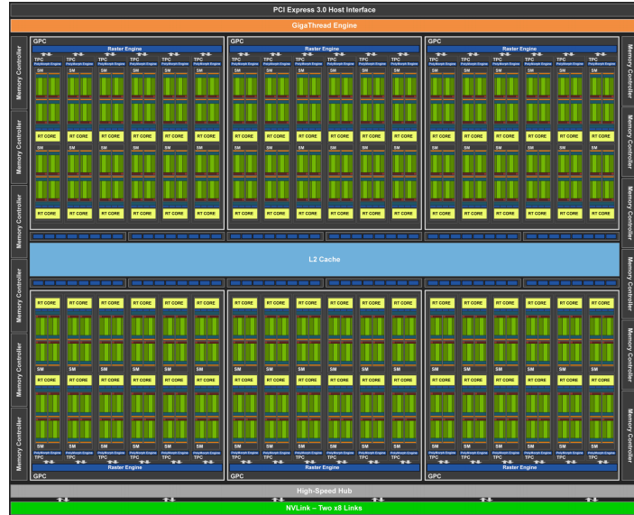
图12.4.8: NVIDIA Turing架构 (图片由英伟达提供)
