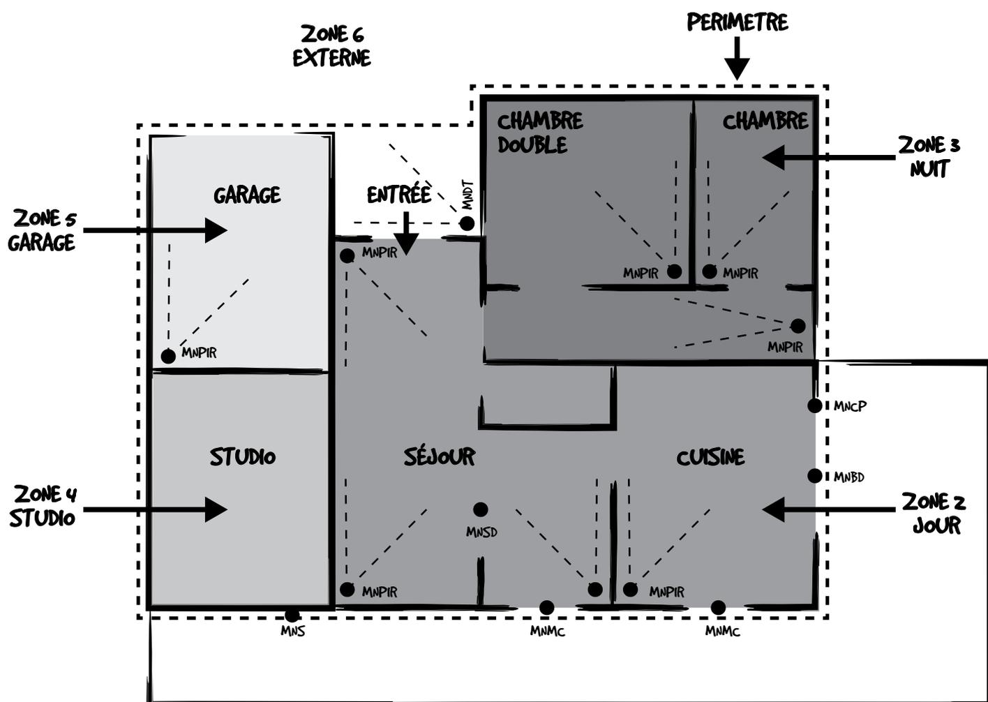
**Avant de procéder à la programmation, dessiner le plan des pièces à protéger et indiquer sur ce dernier les points exacts où les différents dispositifs doivent être placés.**
