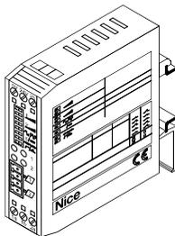
Para la proyección e instalación de las espiras inductivas se debe tener en consideración la tabla al lado. Para realizar la espira se puede utilizar un conductor de cobre aislado normal, preferiblemente de 1,5 mm<sup>2</sup>. Los dos extremos del cable deben estar trenzados entre sí (al menos 20 veces por metro) desde la espira hasta el detector.
