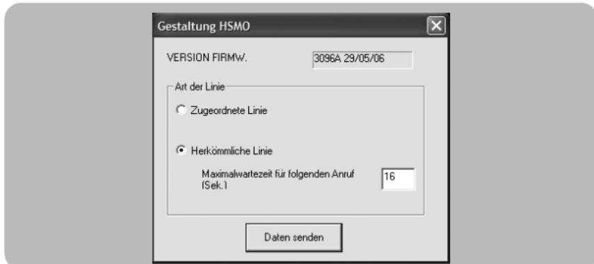
Dieses Fenster ermöglicht die Auswahl der verwendeten Telefonanschlussart:
