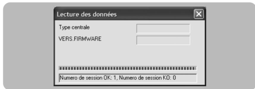
Cette fenêtre permet de télécharger toutes les données « en attente » dans le modem ; il est possible de voir les données dans la fenêtre successive « Fiche technique » (voir paragraphe 4.2.3).
