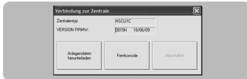
In diesem Fenster können die überarbeiteten Daten der Anlage herunter geladen werden (**herunterladen der Anlagendaten**) oder die "**Fernkonsole**" aktiviert werden, wenn der Anschluss an eine Zentrale vorliegt (direkt oder über Modem).
