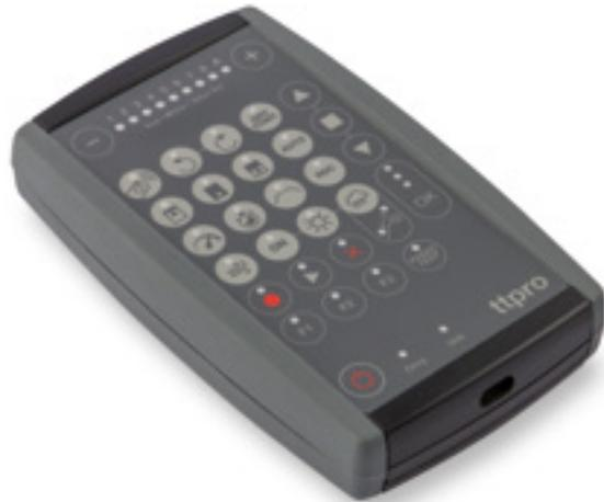
**Programador de mano para motores tubulares Nice con la tecnología TTBus, o dry contact o con radio bidireccional.**
