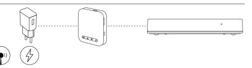
En cas de panne de courant, l'appareil bascule automatiquement sur une source de secours. Après une coupure du réseau électrique, HubPowerbank peut fournir de l'énergie et une connexion Internet jusqu'à 12 heures.
