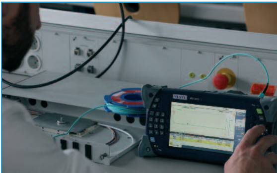
Für 15.000 € entstand ein Messplatz mit OTDR (Optical-Time-Domain-Reflectometry) zum Untersuchen einer Glasfaser Datenleitung
