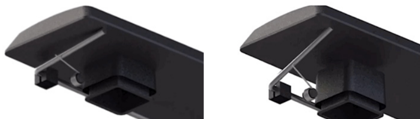
Afbeelding 4. Structuur met torsieveren helpt het geluid te verminderen door het stangetje en de toets stevig bij elkaar te houden.
