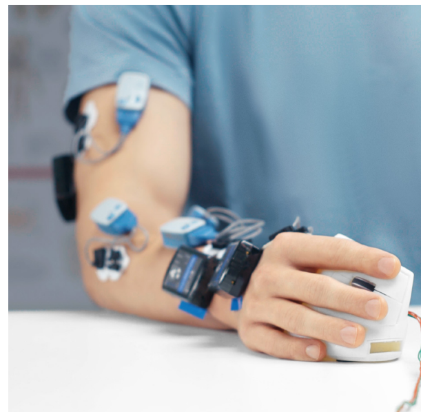
Pengujian ergonomika Logitech dengan motion capture sensor
