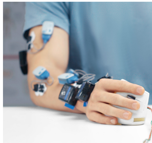
Ergonomische Tests von Logitech mit Motion-Capture-Sensoren
