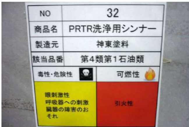
掲示パネルにて有害性・危険性を周知 (コクヨ芝山工場)
