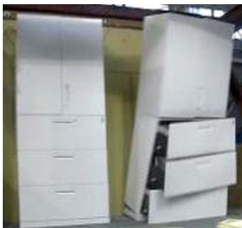
震度6強相当 左:壁固定有 右:壁固定無
