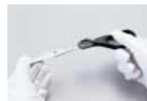
4. 刃部をハンドルから引き抜きます。 注意: 刃部の保持には軍手などを使用するようにし、直接刃部を手で握らないようにしてください。
