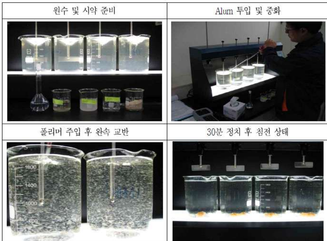
<그림 4-1> 응집침전실험(Jar-Test) 사진
