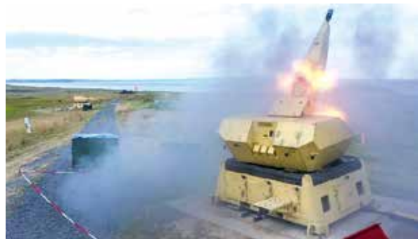
© Bundeswehr oben: Sensoreinheit „Auge“ MANTIS, unten: System-Geschütz beim Schuss. Es schützt gegen Angriffe mit Raketen, Artilleriegeschossen und Mörsern, sogenannten RAM-Zielen (Rolling Airframe Missile).
