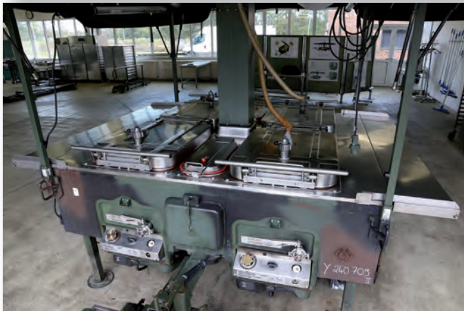
Abb. 3: TFK 250: Küchenanhänger und Zugfahrzeug im Transportzustand (oben links); Küchenanhänger im Aufbau – der hintere Teil des Daches ist noch heruntergeklappt (oben rechts); Küche im betriebsbereiten Zustand (A. und B. = Druckkochkessel mit dahinterliegenden Druckbratkessel, C.= Warmwasserkessel, D.= Abgedeckt: Kurzzeitwecker, Ablasshahn für Warmwasserkessel und Manometer) (unten links); Rüstsatzträger Typ3 (mit Kühlschrank im Hintergrund) auf Lkw 5t (unten rechts) (Fotos: Logistikschule der Bundeswehr)
