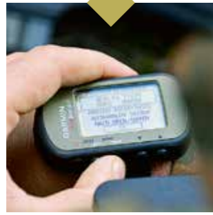
Ein GPS-Empfänger hilft die richtige Position des Wetterballons zu bestimmen
