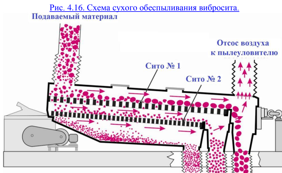
Рис. 4.16. Схема сухого обеспыливания вибросита
