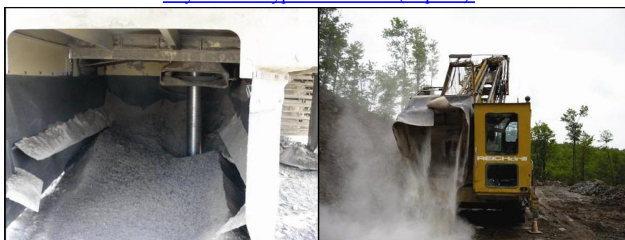
Рис. 3.11. Накопление пыли на полках (слева) и происходящее из-за этого сильное запыление воздуха при опускании буровой мачты (справа).
