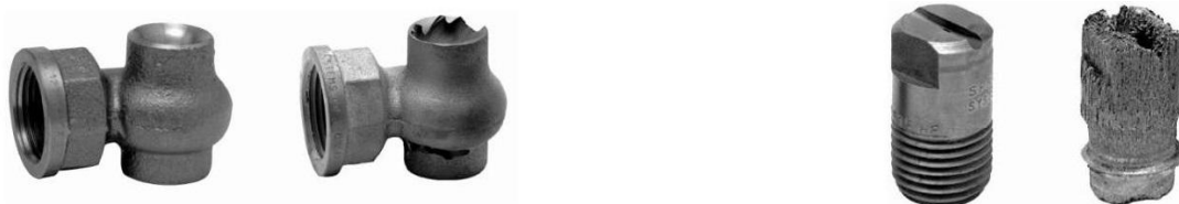
Рис. 2.15. Износ форсунок – старая и новая [Schick 2006] Рис. 2.16. Коррозия форсунок – старая и новая [Schick 2006]
