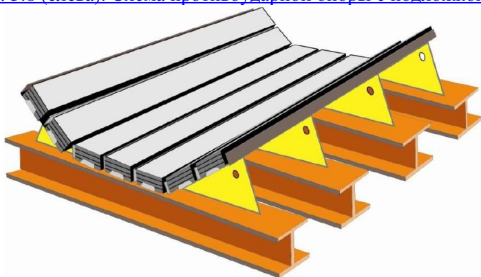
Рис. 5.8. Схема противоударной опоры с подложкой из слоёв резины
