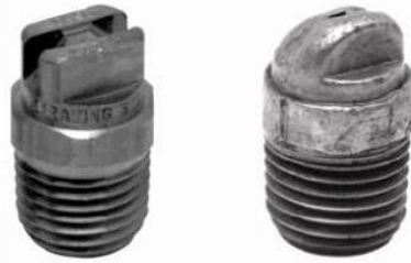
Рис. 2.19. Повреждение сопел форсунок - новая и использованная [SSCO 2003].
