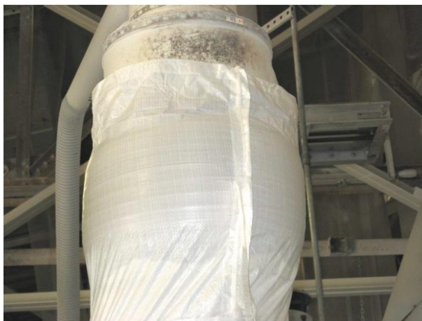
Рис. 6.20. Расширяющийся мешок из неопреновой резины, используемый при заполнении мягких контейнеров
