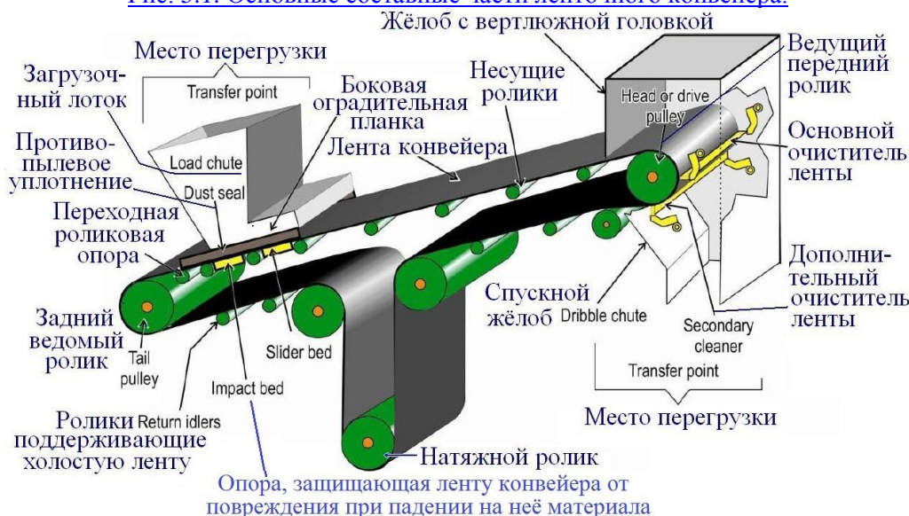
Рис. 5.1. Основные составные части ленточного конвейера.
