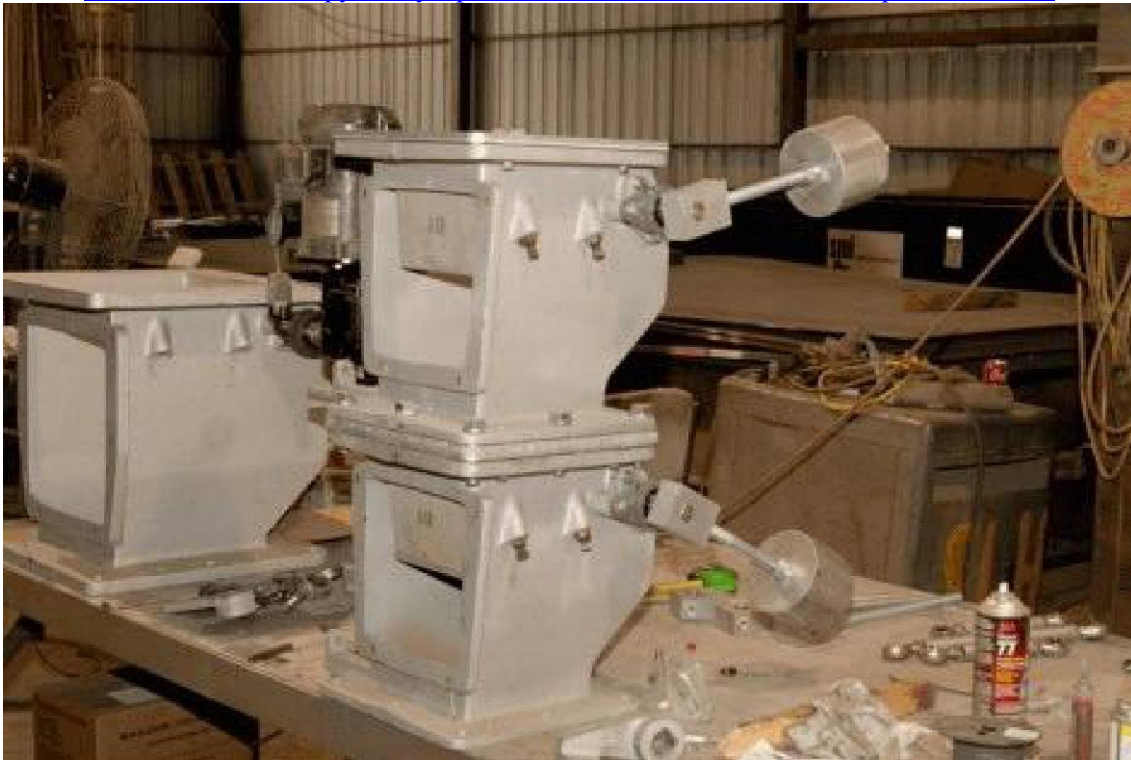
Рис. 1.24. Пылевывозное устройство типа двойная мигалка с противовесами
