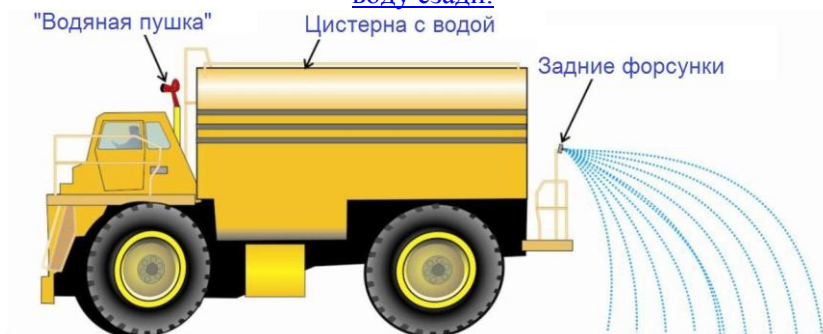
Рис. 10.6. Автомобиль с цистерной, оборудованный передней “водяной пушкой” и форсунками, распыляющими воду сзади.
