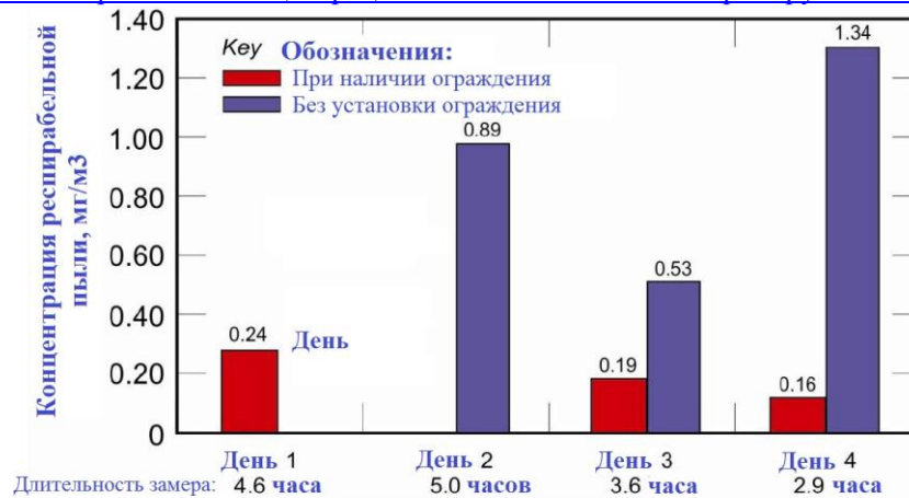
Рис. 3.14. Сравнение концентраций пыли в месте её неконтролируемого сброса. Видно, что установка ограждения снижает концентрацию респираторной пыли в месте её выгрузки на 63-88 %.
