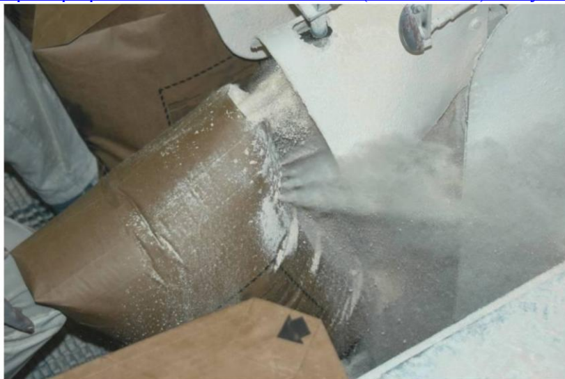
Рис. 6.4. Отверстия около клапана выпускают наружу воздух, вытесняемый загружаемым продуктом, и уменьшают риск разрыва мешка. Видно вытекание (запылённого) воздуха и продукта.
