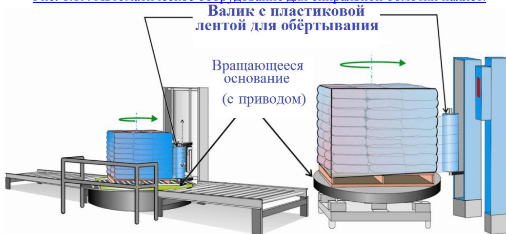
Рис. 6.19. Автоматическое оборудование для спиральной обмотки паллет.
