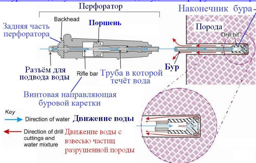
Рис. 3.18. Схема движения воды при мокром бурении показывает, как смывается разрушенная порода. Вода течёт через полый бур и выходит у его наконечника для удаления разрушенной породы из скважины
