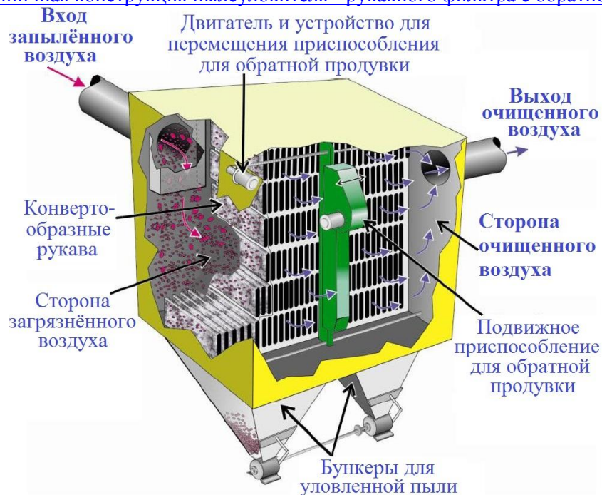
Рис. 1.18 Типичная конструкция пылеуловителя - рукавного фильтра с обратной продувкой
