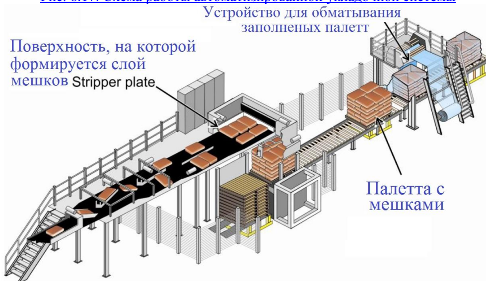
Рис. 6.17. Схема работы автоматизированной укладочной системы
