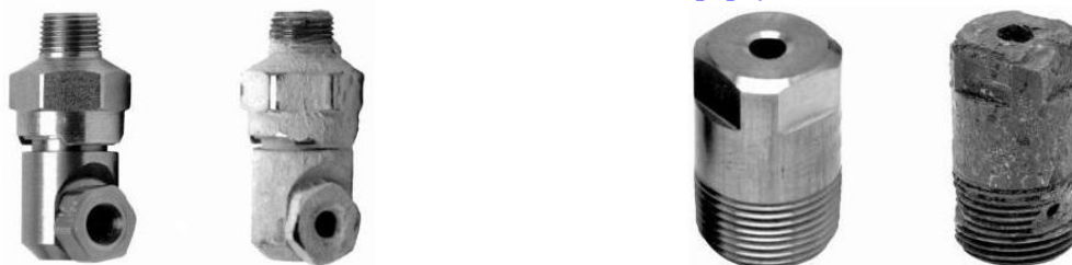
Рис. 2.17. Отложение растворённых веществ Рис. 2.18. Повреждение перегревом – новая - старая и новая форсунки [Schick 2006]. и использованная форсунки [SSCO 2004].
