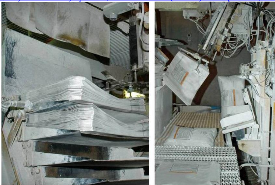
Рис. 6.13. Слева показаны полки для складывания пустых мешков; справа показан манипулятор, устанавливающий пустые мешки в устройство для их заполнения (используются "присоски" для захвата мешков).
