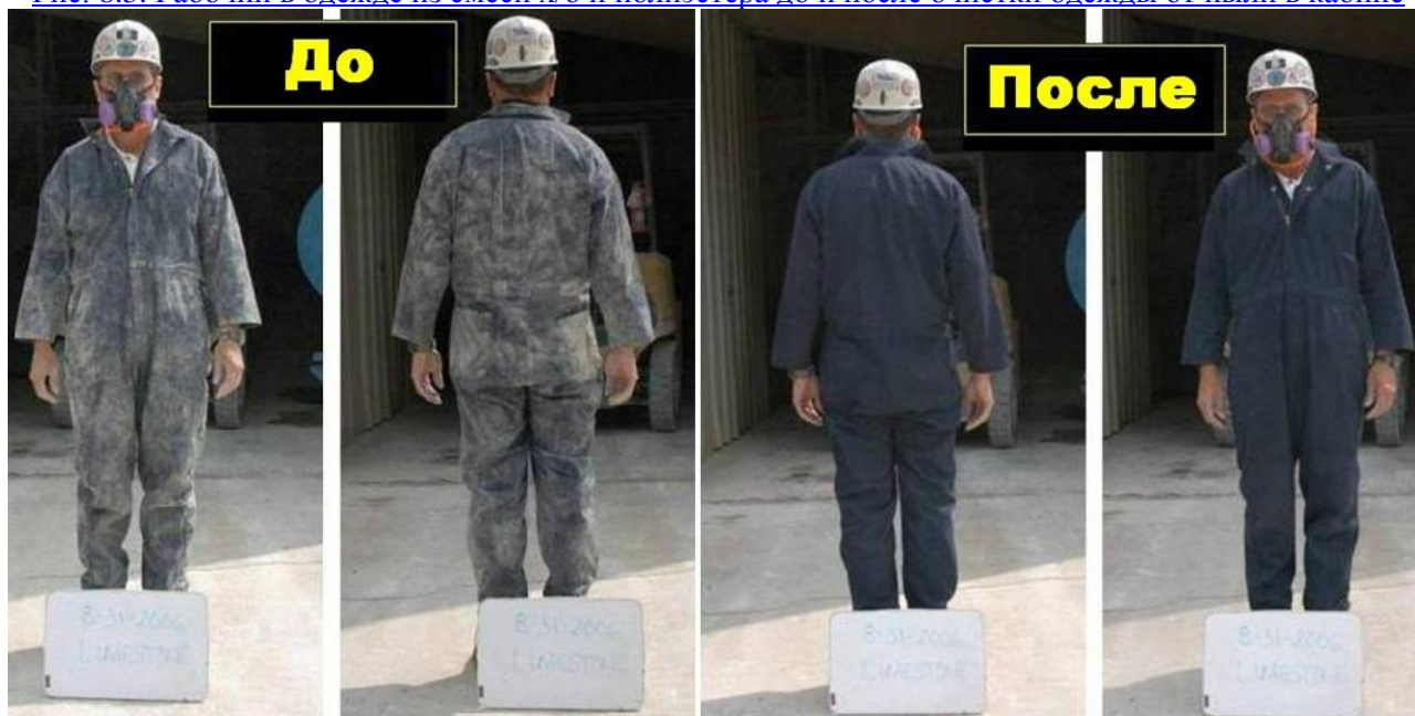
Рис. 8.3. Рабочий в одежде из смеси х/б и полиэстера до и после очистки одежды от пыли в кабине
