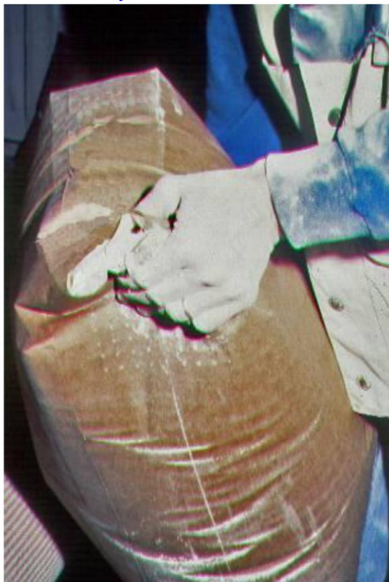
Рис. 8.11. Рабочий вручную закрывает клапан мешка сразу после вынимания сопла загрузки материала, что значительно уменьшает воздействие пыли.
