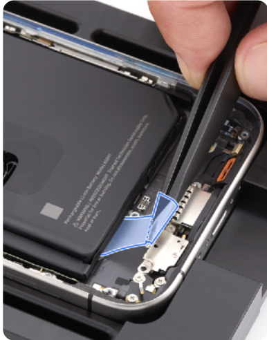
iPhone-Batterien werden mithilfe moderner Klebestreifen gesichert, die sich beim Ziehen in eine bestimmte Richtung lösen und so den Batterietausch ermöglichen.
