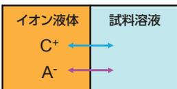
イオン液体の水溶液への分配平衡が液間電位差を支配
