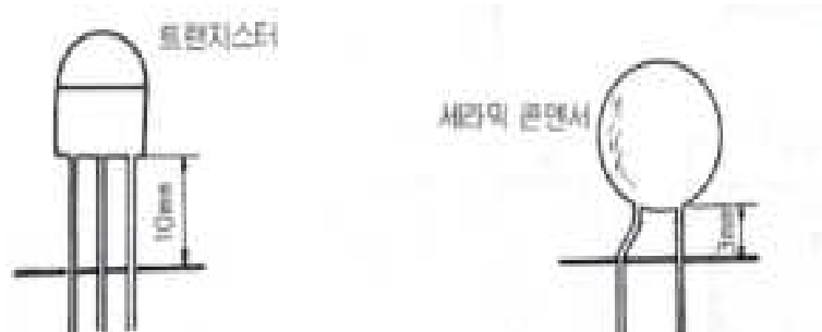
<그림. 트랜지스터 및 세라믹콘덴서의 배치>
