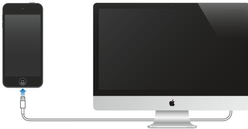
**Importante:** La batteria di iPod touch potrebbe scaricarsi invece di ricaricarsi se iPod touch è collegato a un computer spento, in stato di stop o in modalità standby.
