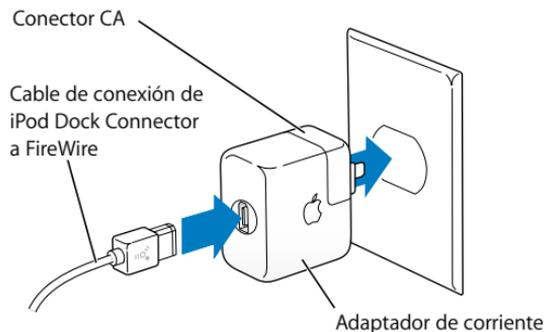
**Advertencia:** Compruebe que el adaptador de corriente está perfectamente acoplado antes de enchufarlo a la toma de corriente.
