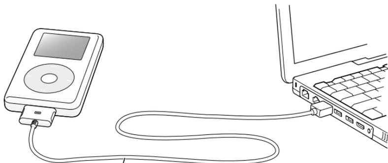
Si va a realizar la conexión mediante un puerto FireWire 400, utilice el cable de conexión de iPod Dock Connector a FireWire. Si lo hace mediante un puerto USB 2.0 de alta potencia, utilice el cable de conexión de iPod Dock Connector a USB 2.0.
