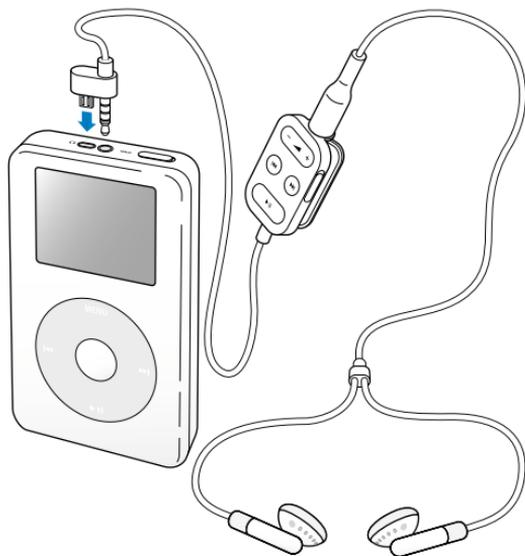
El interruptor de bloqueo (Hold) del mando a distancia sirve para desactivar los botones del mando. Este interruptor y el interruptor de bloqueo situado en el iPod photo son independientes.
