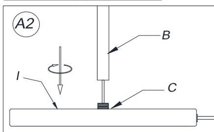
2. Tirar suavemente del exceso del cable eléctrico de la base (I). Colocar el extremo inferior del tubo inferior (B) en la boquilla roscada (C) de la base (I). Rotar el tubo inferior (B) en el sentido de las agujas del reloj hasta ajustar.
