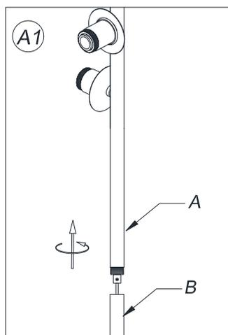
1. Colocar el tubo inferior (B) en el tubo superior (A). Girar el tubo inferior (B) en el sentido de las agujas del reloj hasta ajustar.
