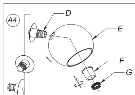
4. Colocar las pantallas de vidrio (E) en los portalámparas (D). Colocar los separadores (F) en los portalámparas (D) y después asegurar las pantallas de vidrio (E) y los separadores (F). Para hacerlo rotar los anillos portalámparas (G) en el sentido de las agujas del reloj hasta ajustar.
