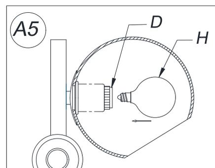
5. Insertar las bombillas especificadas en los portalámparas (D). NO EXCEDER LA POTENCIA ESPECIFICADA.
