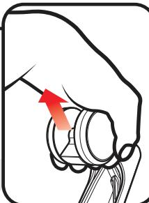
**03** 各ホイールベースのソケットに固定スタンドの各脚部を完全に挿入します。
