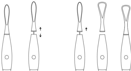
Все головки щетки ISSA совместимы с диапазоном ISSA 2. Чтобы заменить головку щетки, убедитесь, что ваша ISSA 2 sensitive выключена и потяните головку щетки прямо вверх до отсоединения. Когда щетинки сменной головки обращены вперед, выровняйте центральное отверстие с помощью металлического дюбеля и сильно нажмите, чтобы надежно прикрепить.
